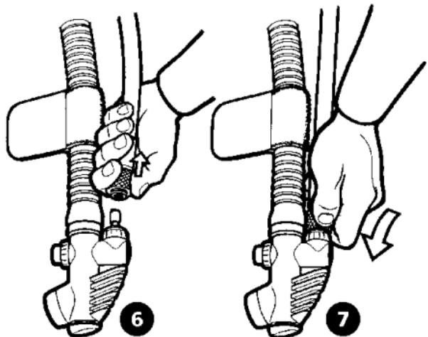
**B > Conexión al hinchador DS mediante el racor rápido:**
