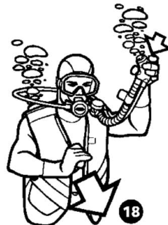
**C > Uitlaatventiel onder:** dit ventiel zit rechtsonder aan de achterzijde van het trimjack.
