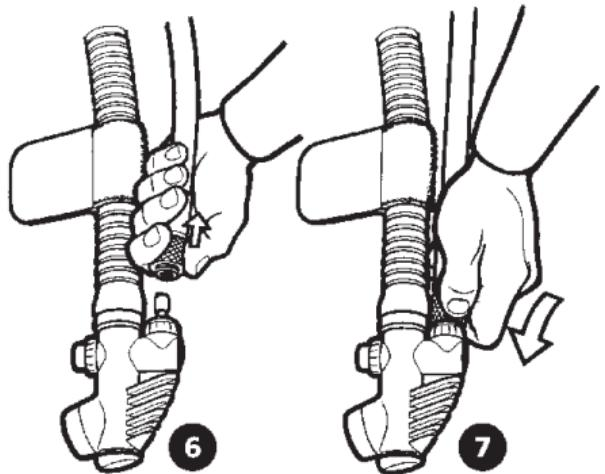
**B > A gyorsfelfújó csatlakoztatása a gyorscsatlakozó segítségével:**
