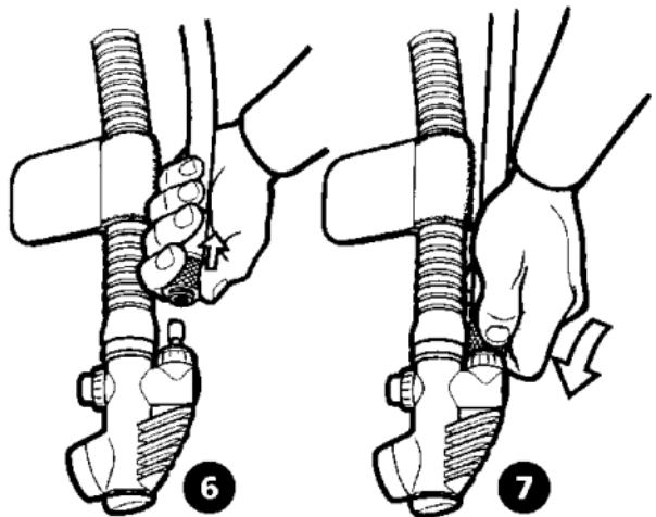
**B > Montagem do inflador automático com o conector rápido:**
