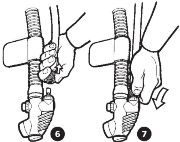
**В > Соединение инфлятора с быстрым разъёмом:**
